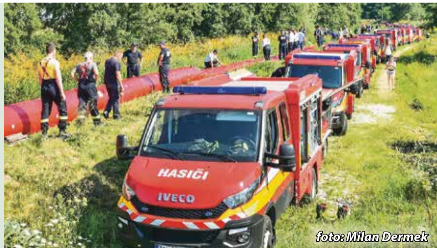
Protipovodňové bariéry boli plnené pomocou kalových alebo plávajúcich čerpadiel vodou z rieky Bebrava
